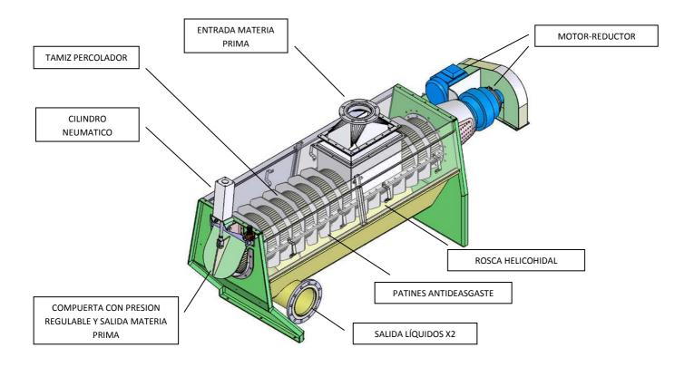
El funcionamiento de la máquina consta de los siguientes pasos:
