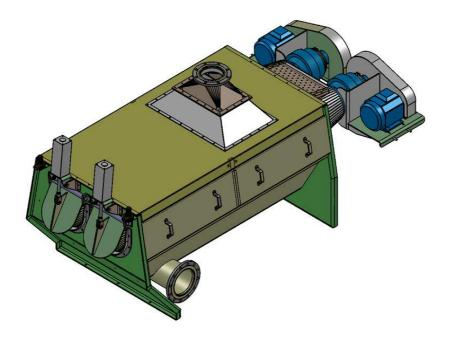
Maquina fabricada en acero Inoxidable que nos ofrece la posibilidad de reducir la humedad proveniente del transporte de plumas y pelo a más del 55%.
